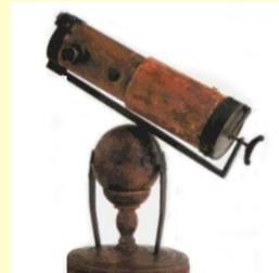
Telescopio de Newton que consistía en un espejo cóncavo.
